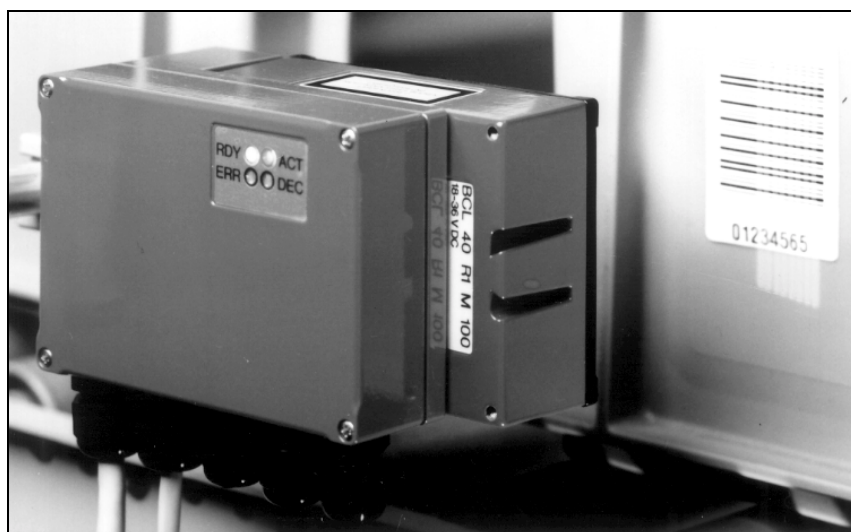
Figure 6.3 : Exemple de fixation de l'ensemble compact BCL 40 / MA 10
