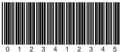
Figure 8.2 : Modèle du code à barres (Code 39 ; 0,35 mm ; rapport d'impression 2:1)
